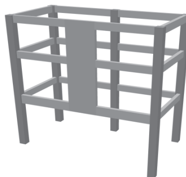
Φυτευτό τοίχωμα σε δοκό (KA 2 )
