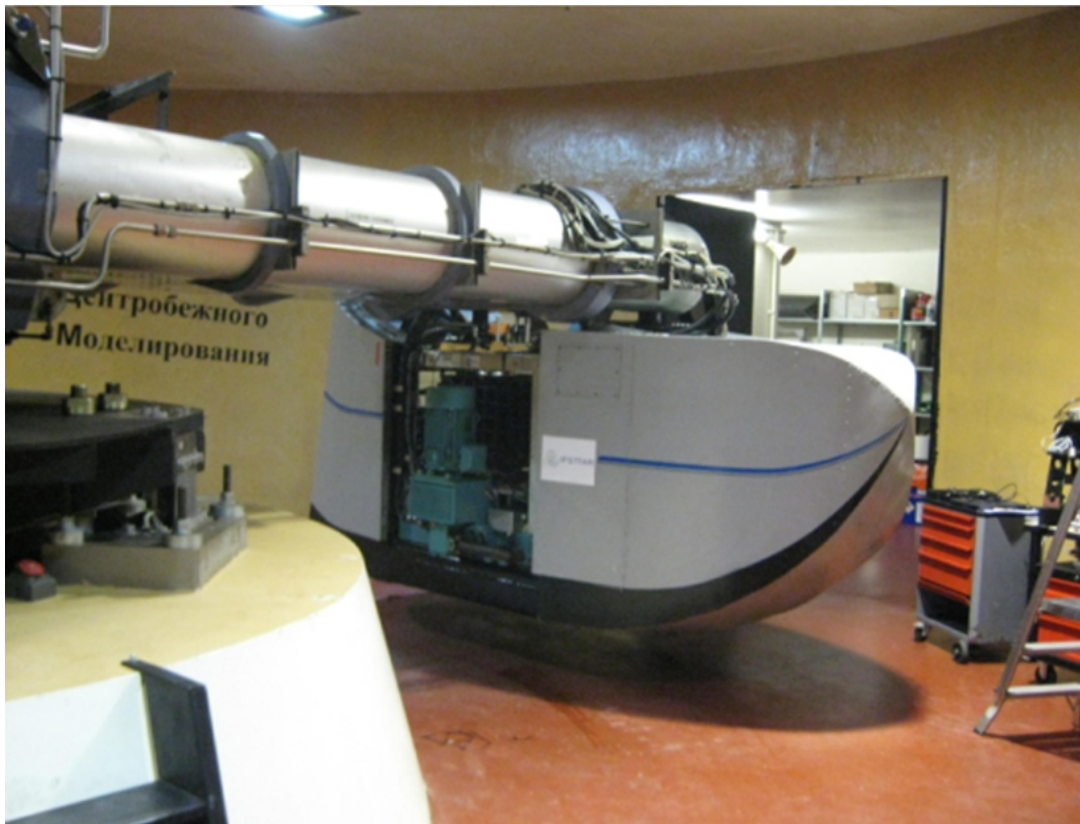
Διάταξη γεωτεχνικού φυγόκεντριστή στο εργαστήριο IFSTAR, Nantes.
