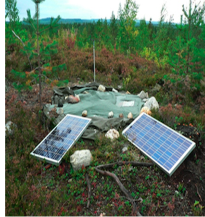
Εγκατάσταση σταθμού καταγραφής Μαγνητοτελλουρικών Δεδομένων μεγάλης διάρκειας
