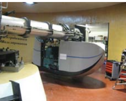
Εικόνα 14. Διάταξη γεωτεχνικού φυγοκεντριστή στο εργαστήριο IFSTTAR, Nantes
