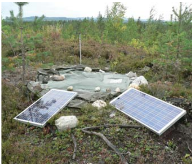
Εικόνα 8. Εγκατάσταση σταθμού καταγραφής Μαγνητοτελλουρικών Δεδομένων μεγάλης διάρκειας
