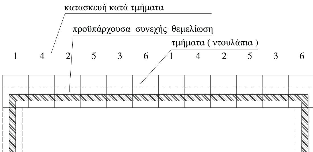
Σχ. 6.7.6 Σειρά εργασιών ενίσχυσης θεμελίωσης κατά τμήματα [9]
