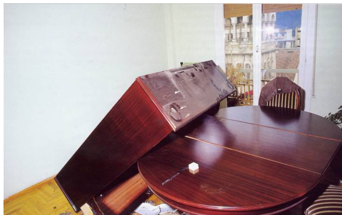
Εικ 3.11α. Καλαμάτα, σεισμός 1986. Το έπιπλο ανατράπηκε επειδή δεν είχε γίνει προσεισμικά κατάλληλη στήριξή του στον τοίχο
