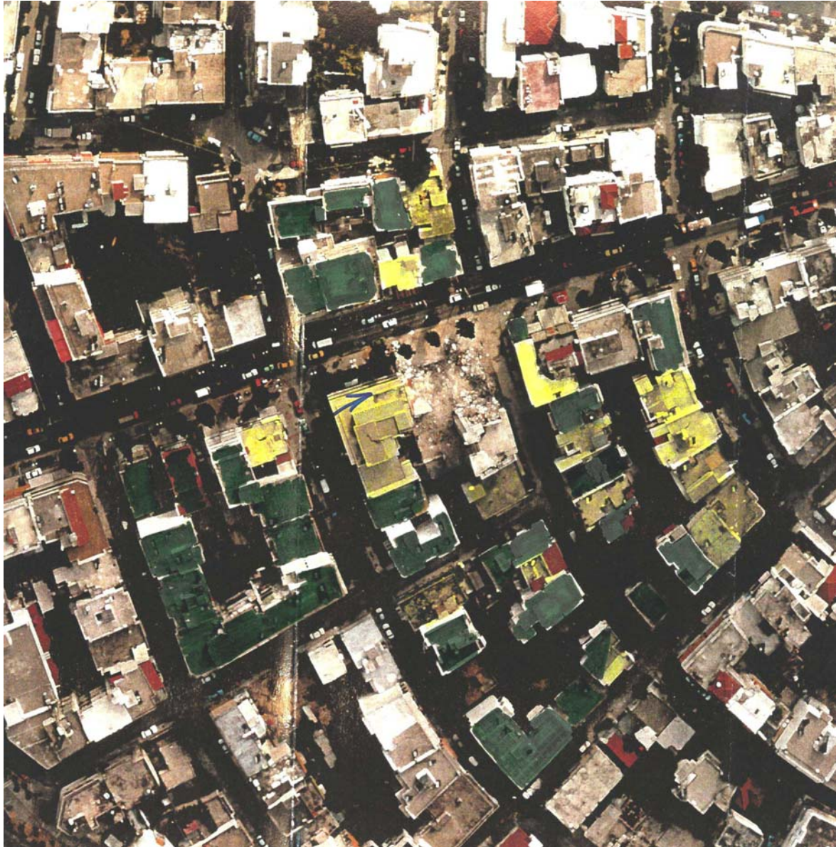
Σχήμα 5.2 Διαδικασία εφαρμογής του Ταχέως Οπτικού Ελέγχου σε γειτονικά οικοδομικά τετράγωνα με κατασκευές οι οποίες εμφάνιζαν διαφορετικό ποσοστό και βαθμό βλάβης.
