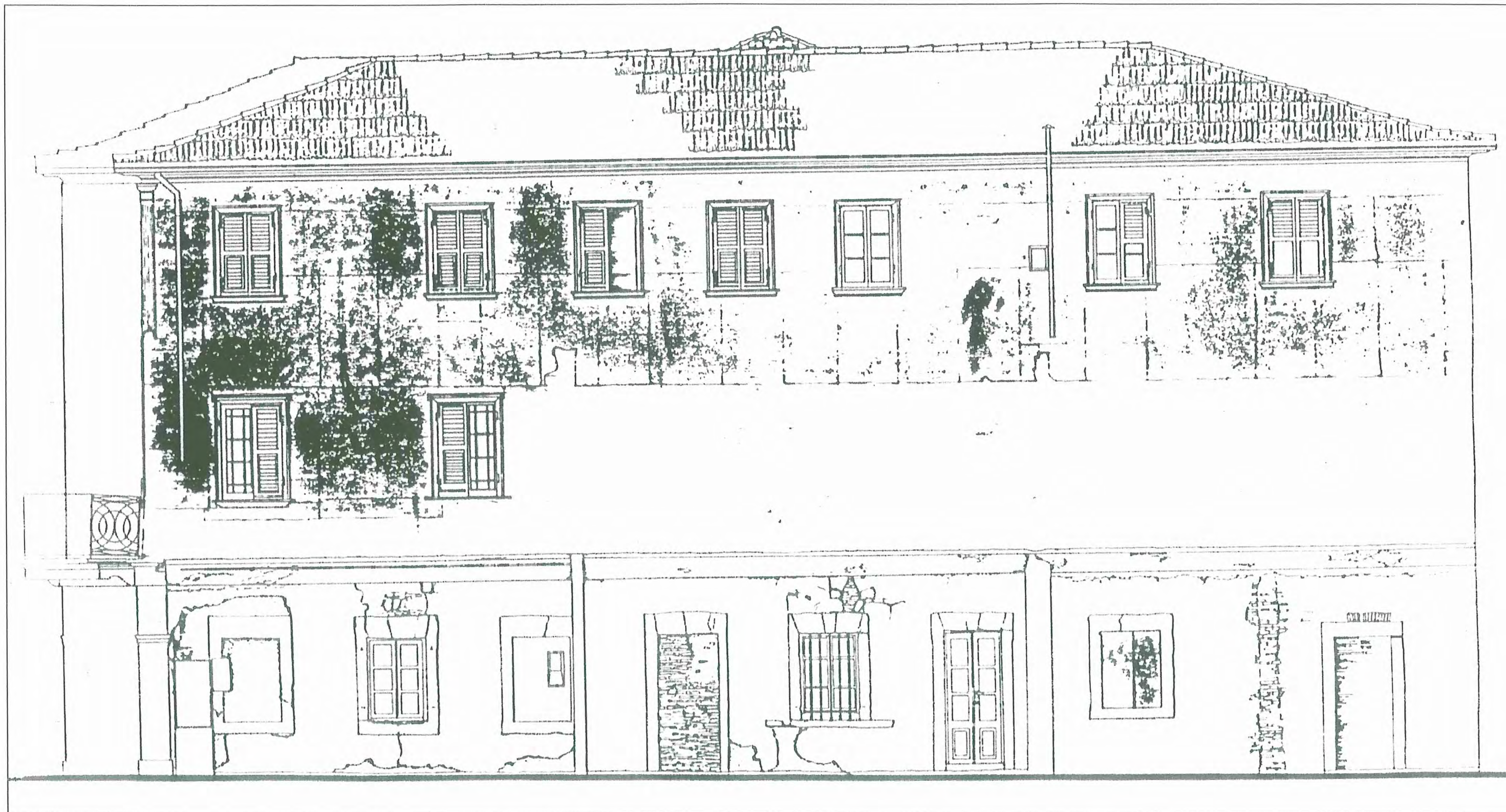
ΣΧ.37 Κτίριο “Βερόκιου” στην κεντρική πλατεία. Οι τοίχοι των ορόφων έχουν επένδυση από λαμαρίνα.
